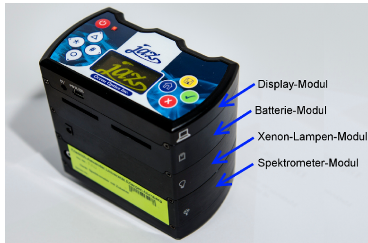
Abbildung 7: Das modulare Spektrometer der Firma Ocean Optics mit seinen verschiedenen Modulen. [1]
