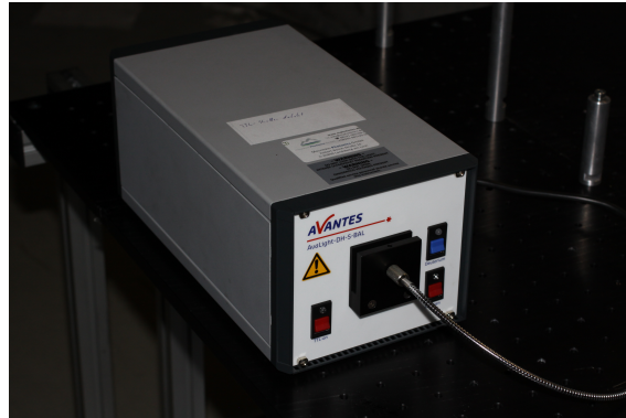
Abbildung 11: Bild der verwendeten Lichtquelle mit angeschlossener Glasfaser.
