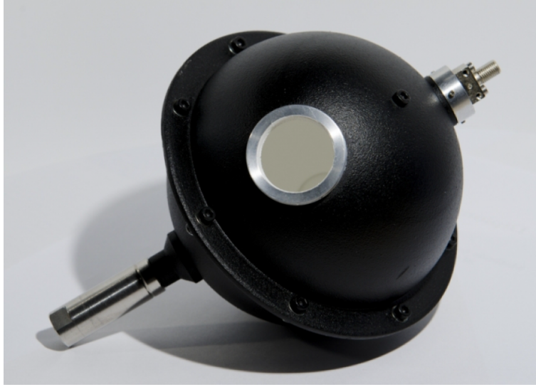
Abbildung 6: Die in diesem Aufbau verwendete Ulbrichtkugel der Firma LOT-Quantum Design. [1]
