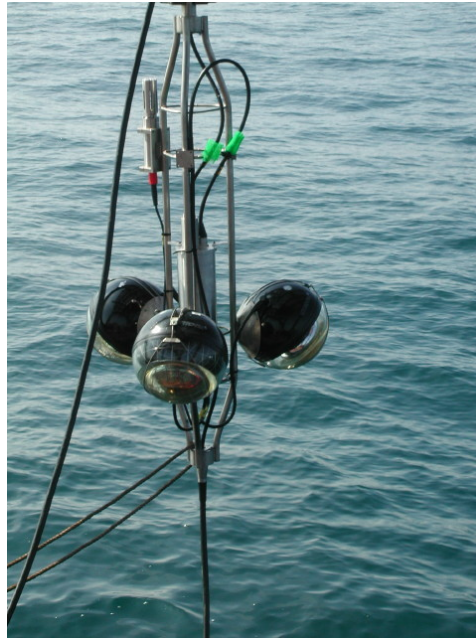
Abbildung 2.4: optisches Stockwerk von Antares: 3 Photomultiplier im Winkel von 120^\circ zueinander angeordnet, blicken unter 45^\circ zum Meeresboden
