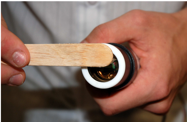
(a) Auftragen des optischen Fetts
