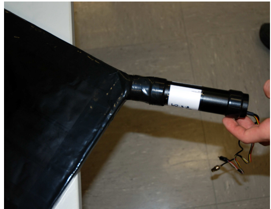
(b) Verbindung von Szintillator und PMT
