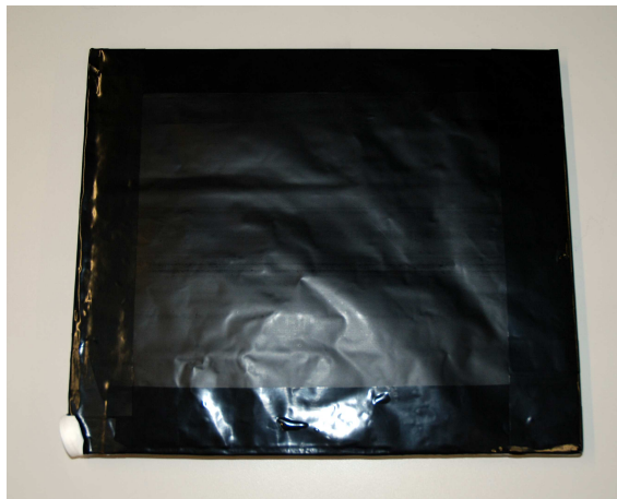
Abbildung 2.2: Lichtdicht verpackte Szintillatorplatte
