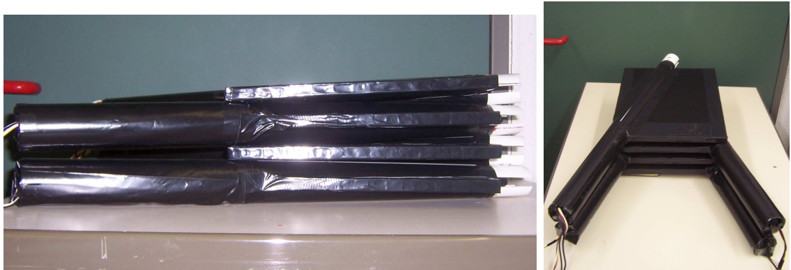
Abbildung 3.10: Gestapelte Detektoren zur Messung der Myonenlebensdauer
