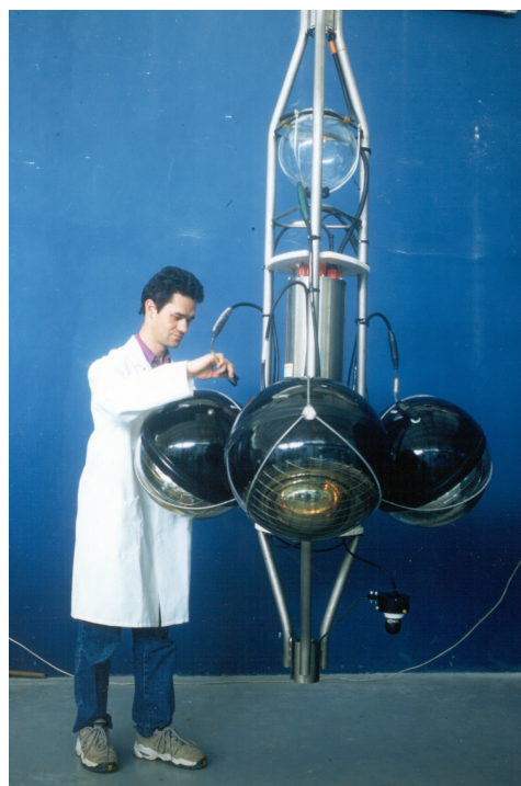
Abbildung 5: Halterung mit drei optischen Modulen bei der Kontrolle [13].
