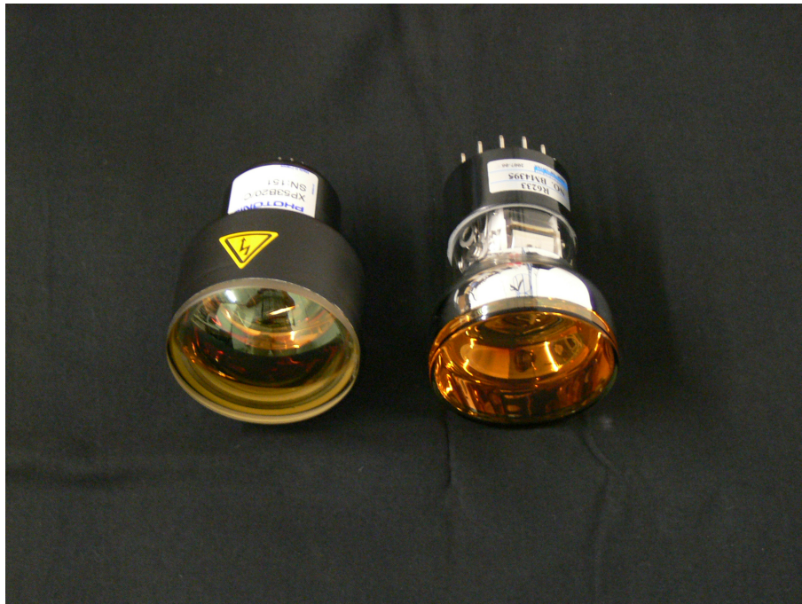
Abbildung 2.3: Links: Photonis XP53B2. Rechts: Hamamatsu R6233
