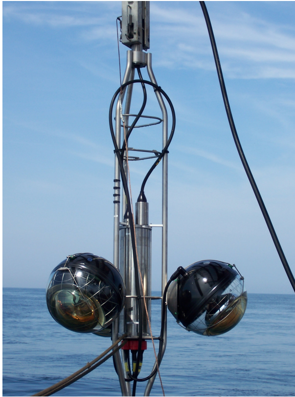
Abbildung 2.3 Ein Stockwerk des ANTARES Detektors. Zwei der drei optischen Module sind deutlich zu erkennen (das dritte OM ist verdeckt).
