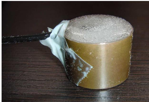
Abbildung 3-4: Bild eines eingegossenen Sensors
