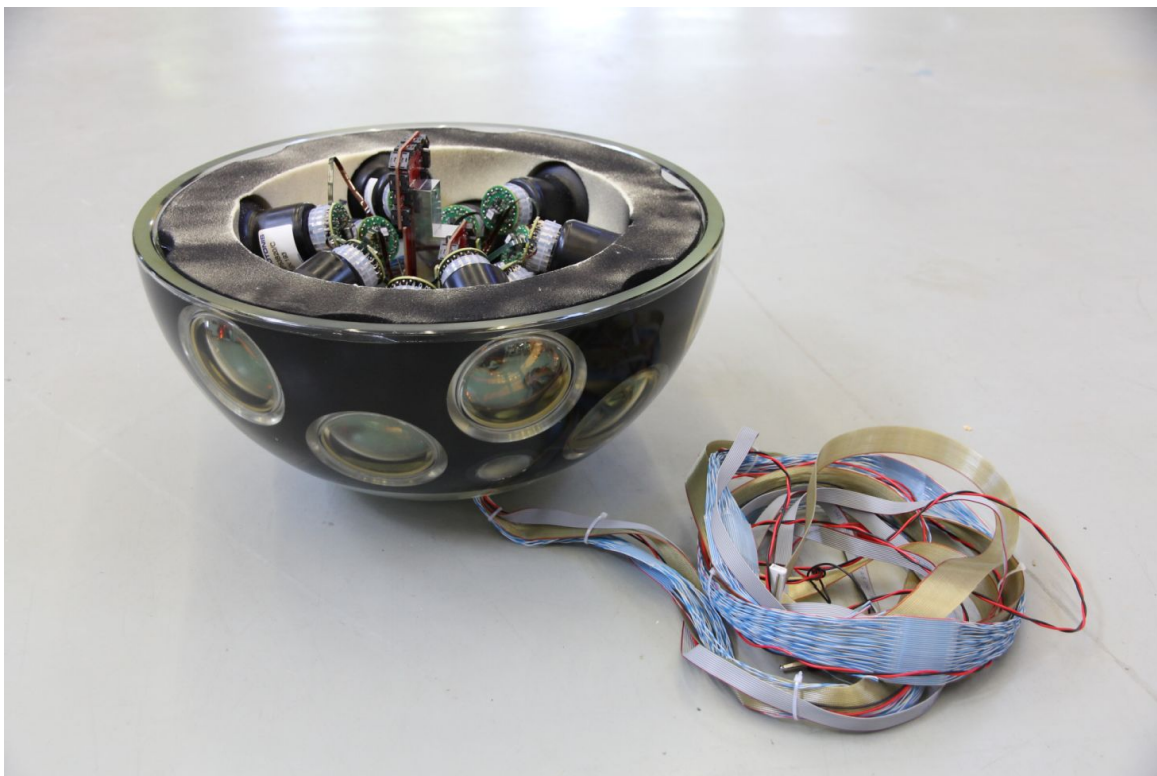
Abbildung 2.1: Hälfte eines DOM-Prototyps mit Photomultipliern und Auslesekarte
