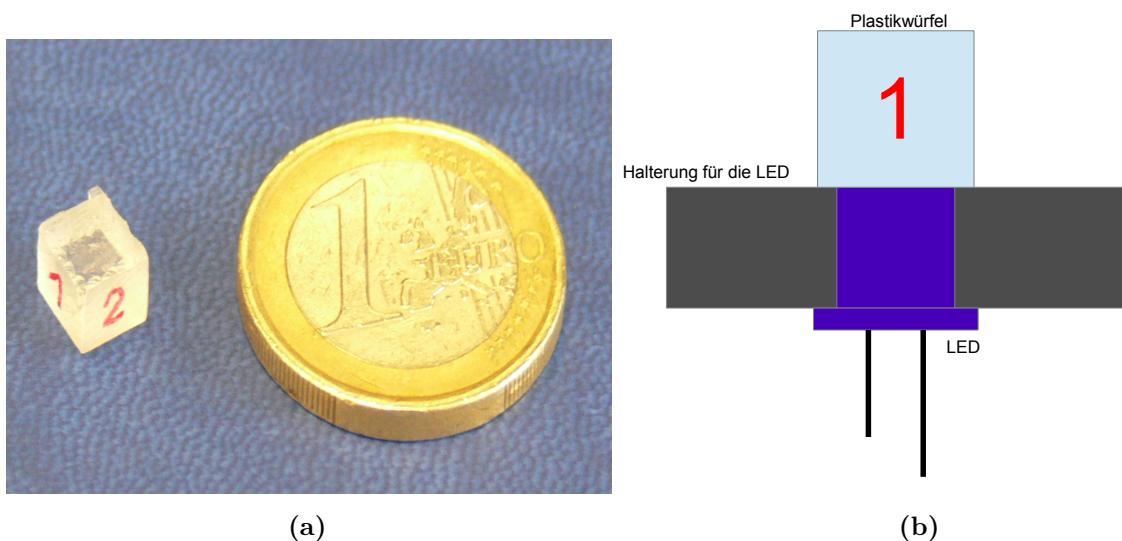
Abbildung 3.6: Abbildung (a) zeigt einen Plastikwürfel, der zur Justierung benutzt wurde im Größenvergleich mit einer Münze. Abbildung (b) zeigt die Anordnung von LED und Plastikwürfel für die Justierung der optischen Geräte.
