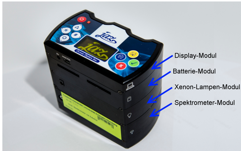
Abbildung 9: JAZ-Spektrometer mit oben sitzendem Display-Modul
