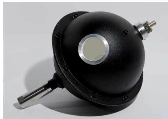
Abbildung 8: Ulbrichtkugel mit Eingangsöffnung und Kuppelung für Lichtfaser (rechts oben im Bild)
