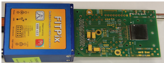
(a) Der Timepix-Detektor E3W83 mit Sensorfläche, elektronisches Chipboard und angeschlossene USB-Ausleseelektronik („Fitpix“).
