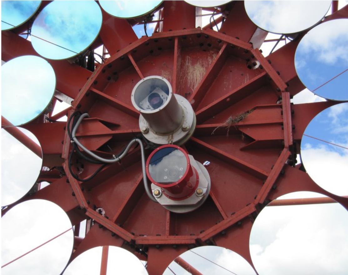
Abbildung 2.1: LidCCD (mitte) und SingleCCD (unten) mit jeweiligem Gehäuse in der Mitte der Spiegelfläche eines kleinen H.E.S.S. Teleskops (CT2) (Lennarz, 2012).
