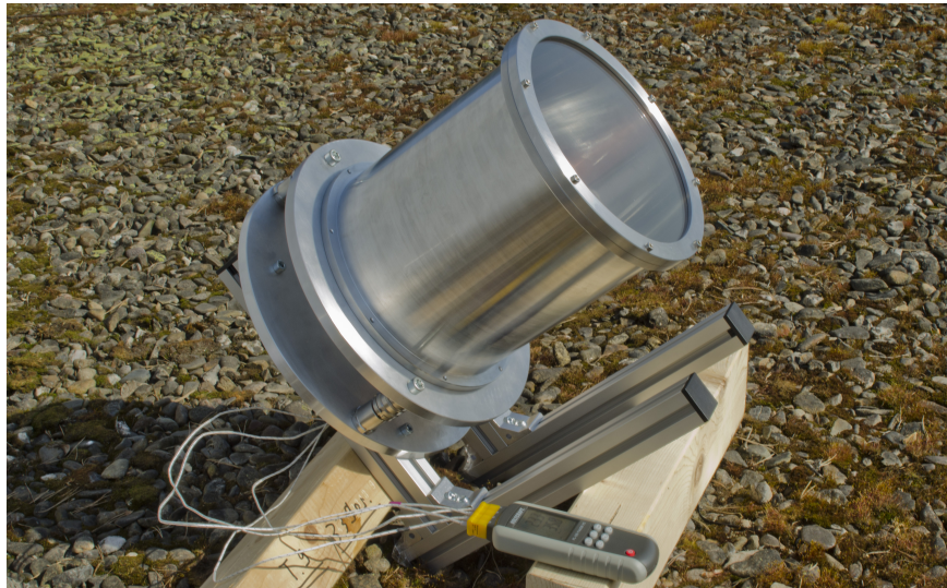
Abbildung 3.12: Auf die Sonne ausgerichtetes Kameragehäuse samt digitalem Thermometer.
