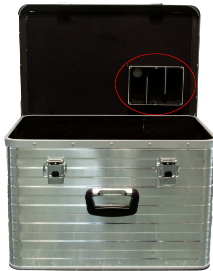
Abbildung III.2: Aluminiumbox zur Licht- und elektrischen Abschirmung. Eine Aluminiumbox der Firma Enders ist mit 3 mm dicken Neopren ausgekleidet. In der Box befinden sich zwei Löcher mit einem Durchmesser von jeweils 3,2 cm, welche die Luftzirkulation unterstützen sollen und gleichzeitig als Kabeldurchführungen verwendet werden können. Um die Luftlöcher ist eine Box angebracht. Sie dient als Kabellabyrinth und ist ebenfalls mit Neopren verkleidet (rot markiert). Mit einem Deckel kann die Box verschlossen werden.
