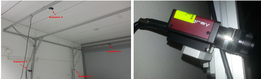
Abbildung 10: Kameras des SWD-PMD Messaufbaus in Erlangen. Links: Position und Montage der Kameras. Rechts: Bild einer einzelnen Kamera
