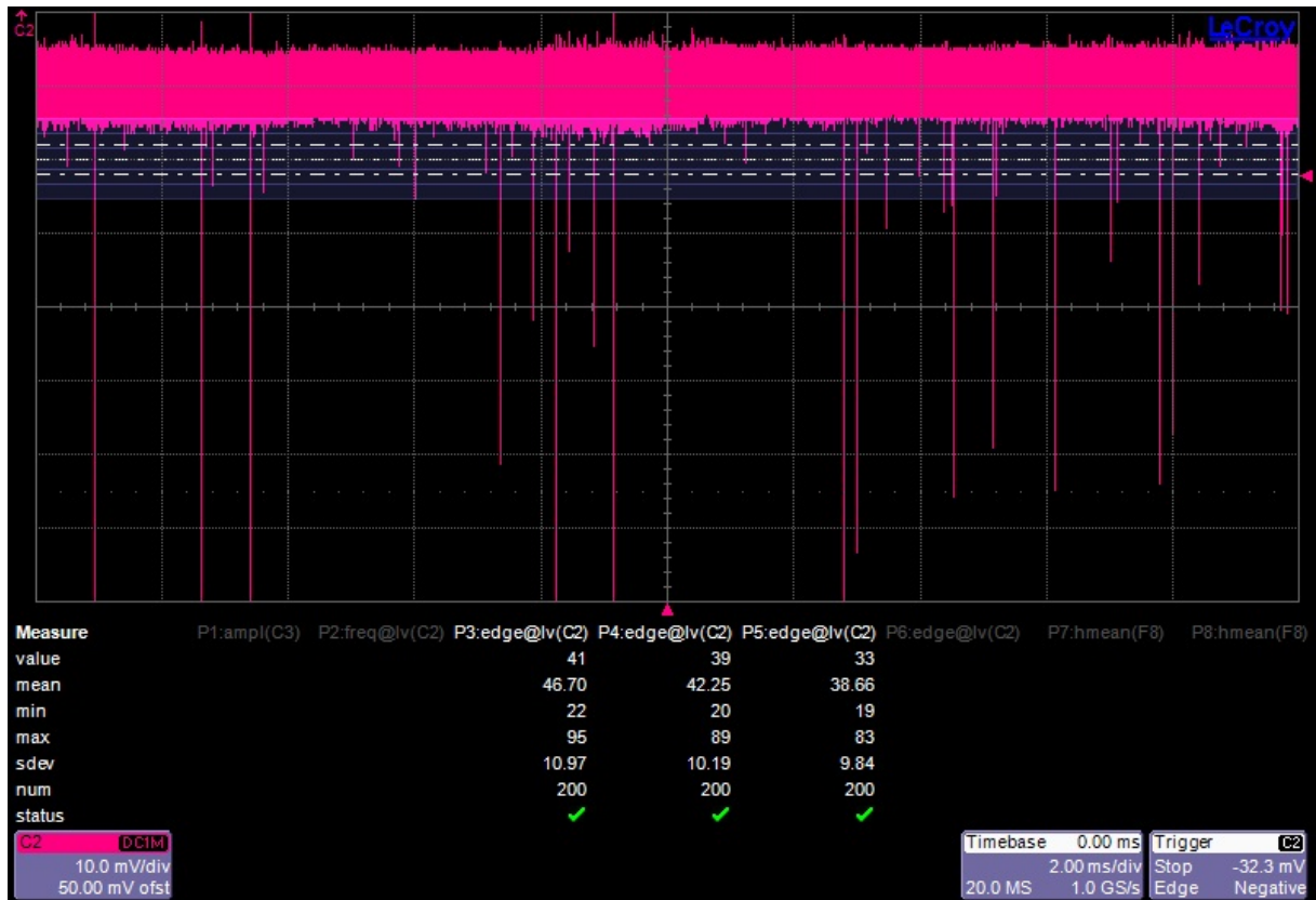
Abbildung 51: Lichtdichtigkeitsmessung bei eingeschaltetem Laborlicht. Die Photokathode des PMTs ist in Richtung Al-Platte ausgerichtet. Zusätzlich wird die Tür beleuchtet.
