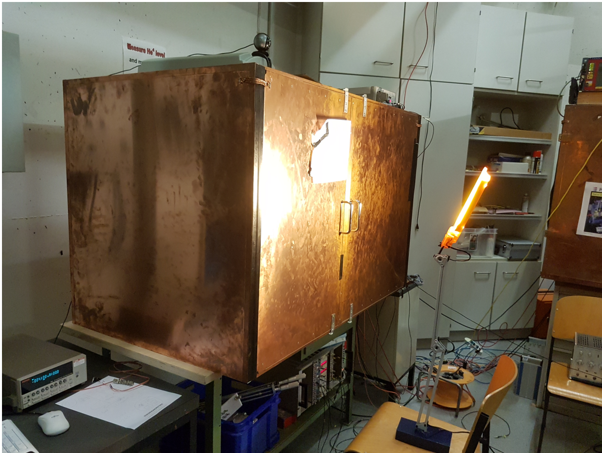
Abbildung 31: Beleuchtung der Vorderseite der Box durch die Schreibtischlampe. Die Seite wird an der Stelle beleuchtet, an der sich die beiden Türen treffen. So wollte man testen, ob durch die Türspalten zusätzliches Licht in die Dunkelkammer eindringt.
