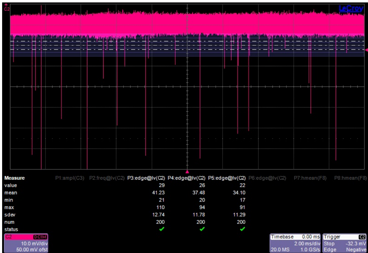
Abbildung 50: Lichtdichtigkeitsmessung bei eingeschaltetem Laborlicht. Die Photokathode des PMTs ist in Richtung Al-Platte ausgerichtet.
