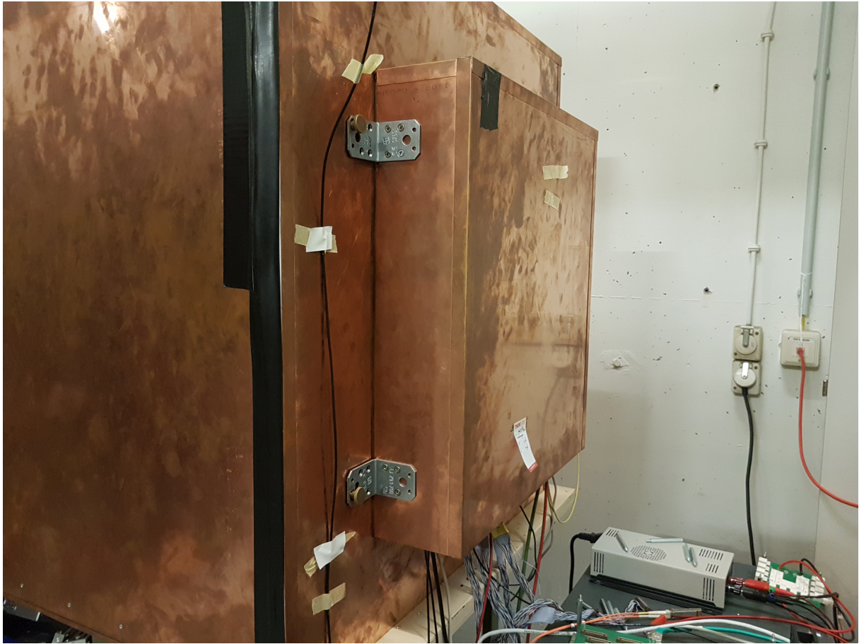
Abbildung 24: Die Abdeckung, welche die Al-Platte vor mehr Lichteinfall schützt. Durch die untere Öffnung werden Kabel von der Al-Platte durchgezogen.
