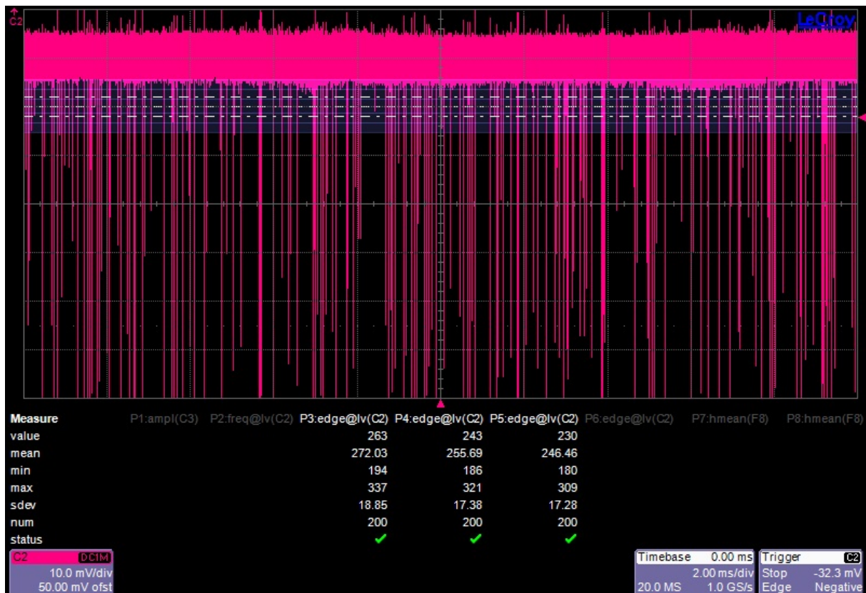
Abbildung 32: Messung der Anzahl an Ereignissen des PMTs am Oszilloskop für den Fall, wenn die Abdeckung vor der Al-Platte geöffnet ist und der PMT in Richtung Platte ausgerichtet ist. Verglichen mit der Messung der Dunkelrate, ist eine deutliche Steigerung in der Anzahl an Ereignissen erkennbar.
