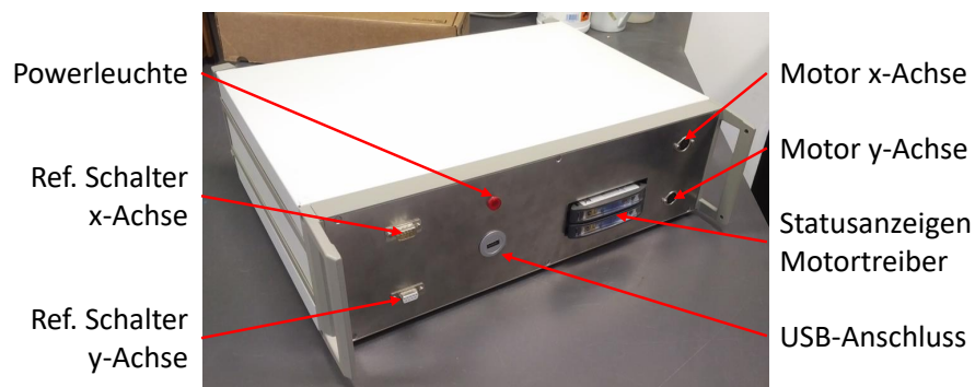
Abbildung 5.2: Bild der Motorsteuerung mit Beschriftung der Steckkontakte
