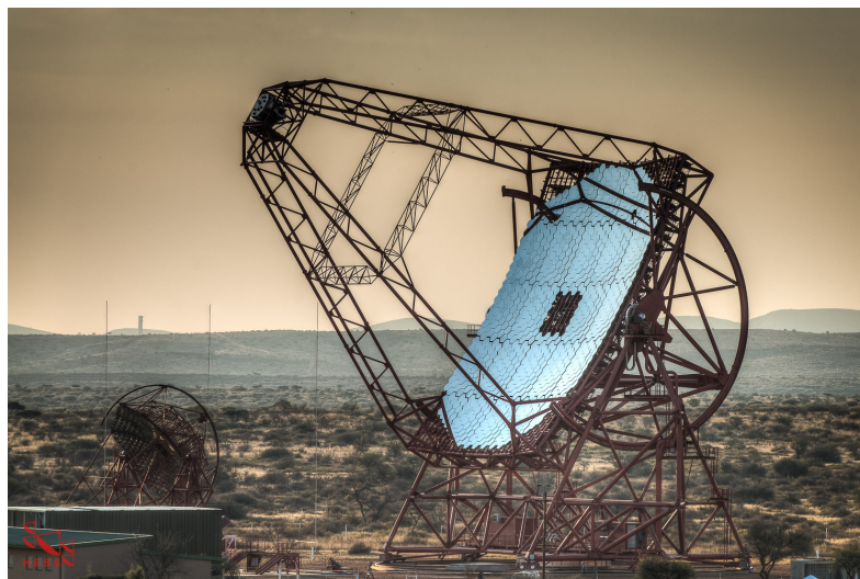
Abbildung 2.6: H.E.S.S. II Teleskop. Es hat eine totale Spiegelfläche von 614 \text{ m}^2 und ein Gesamtgewicht von 580 Tonnen. Die Cherenkov-Kamera nimmt 3600 Bilder pro Sekunde auf und hat eine effektive Belichtungszeit von 16 Nanosekunden. Sie besteht aus 2048 PMTs. Quelle: [17]
