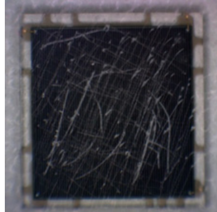
Abbildung 3.6.: Eine stark zerkratzte Oberfläche eines SiPMs, dennoch wird kein signifikanter Abfall des Ansprechverhaltens festgestellt
