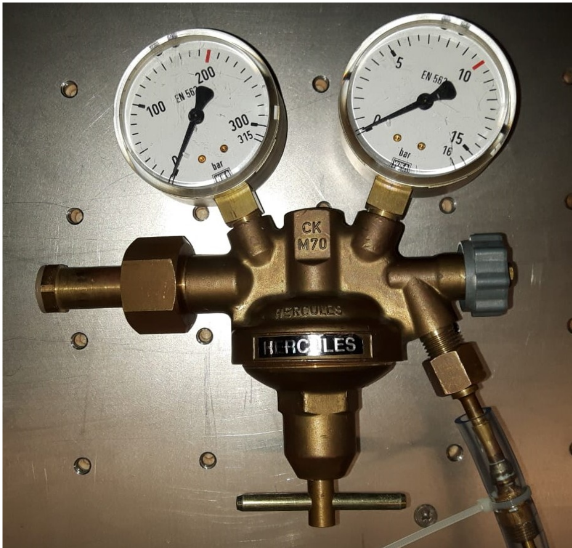
Abbildung 3.2: Druckminderer Hercules CK M70 zur Regulierung des Ausflusses des Stickstoffes.
