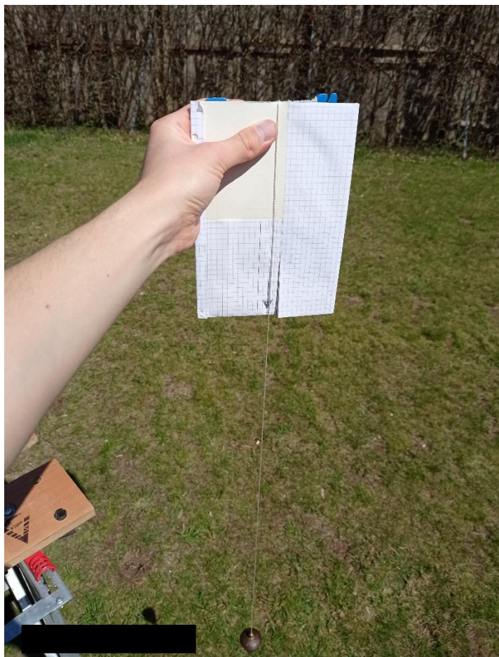
Abbildung 41: Verwendung des Schildes und einem Lot zum Finden der exakten Position der Pflöcke. Der Faden mit dem Lot wird hierbei parallel über den Pfeil auf der Rückseite des Messschildes positioniert.
