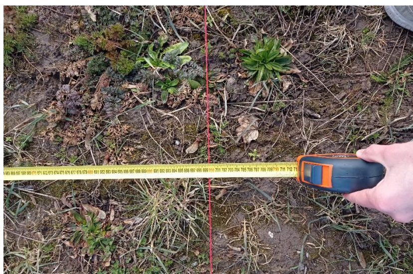
Abbildung 36: Bild zur Messung mit dem Maßband. Zur einfacheren Ausrichtung wurde hierbei das Ende des Maßbandes bei der Platte angesetzt.
