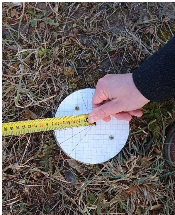
Abbildung 33: Bild zur Ausrichtung des Maßbandes an der Winkelplatte. Die hier verwendete Platte war eine provisorische aus Pappe und wurde mit zwei Schrauben im Boden fixiert.
