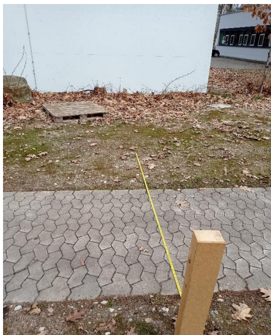
Abbildung 28: Messaufbau zur Genauigkeit des Lasers bei Neuausrichtung. Das zu sehende Maßband war für eine Messung zu kurz, daher musste zweimal gemessen werden. Der Laser wird auf dem Holzpflock positioniert und anschließend auf die Wand ausgerichtet.
