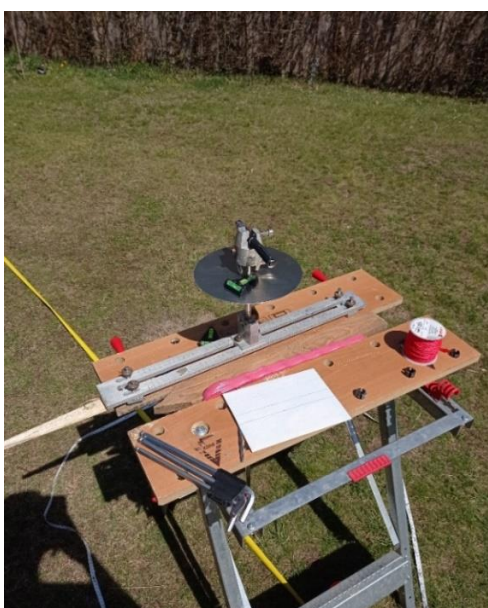
Abbildung 42: Bild des improvisierten Stativs zur Fixierung der Messapparatur.
