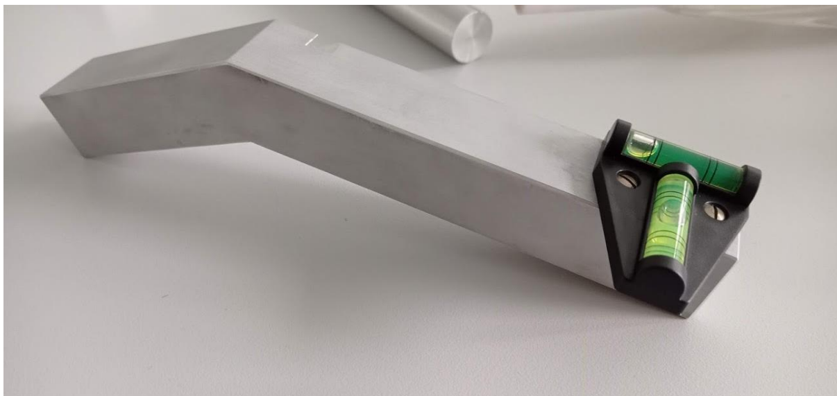
Abbildung 16: Winkel mit daran befestigter Kreuz Wasserwaage. Dieser Winkel erfüllt die Aufgabe des Werkstücks aus Abbildung 15.
