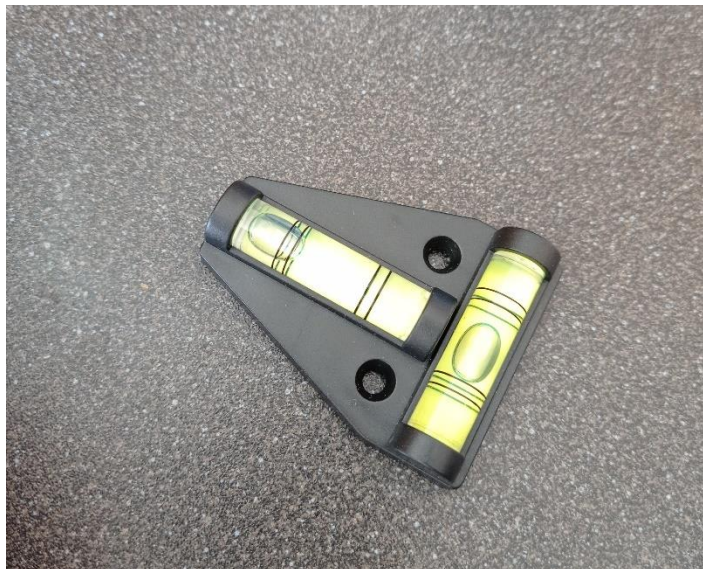
Abbildung 21: Eine Kreuzwasserwaage zur Ausrichtung der Messapparatur und der Antennen relativ zur Oberfläche [11].
