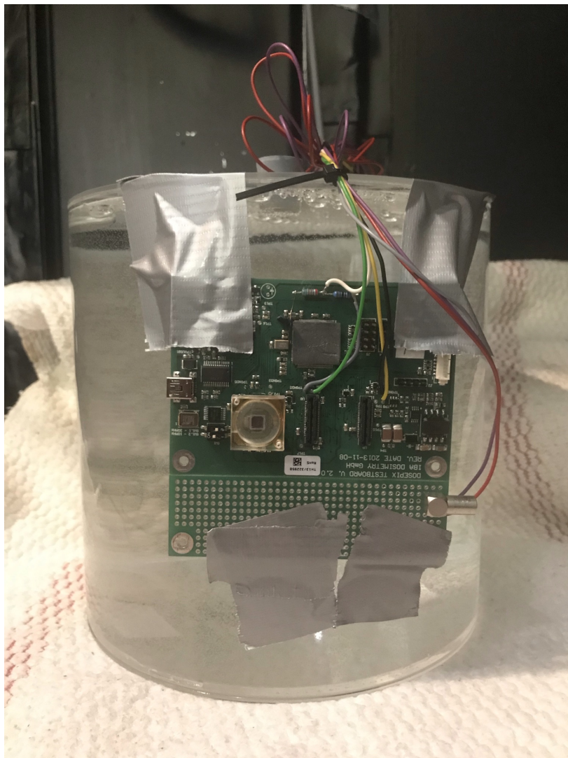
Abbildung A.4: Fotografie des Messaufbaus für die Messung mit Zylinderphantom. Das Board mit dem Dosepix-Detektor wurde frontal auf dem Phantom befestigt.
