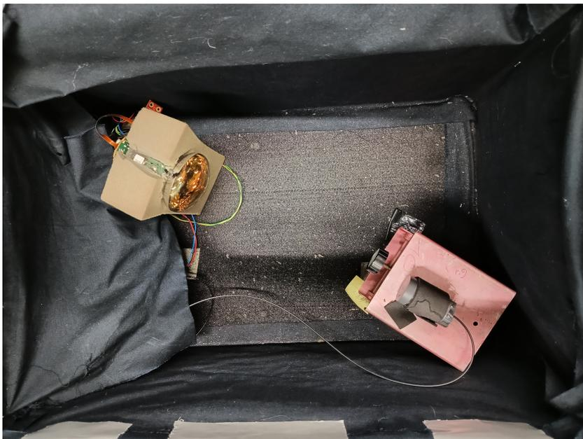
Abbildung 4.1: Foto des Aufbaus für die ToT Messungen. Links befindet sich der PMT, angeschlossen an die aktive Basis und rechts die Halterung für die optische Faser. In der Halterung ist auch ein Milchglas verbaut um den Laser aufzufächern.
