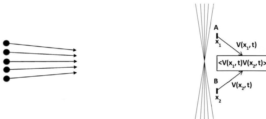
Abbildung 3: Veranschaulicht wird, wie eine ausgedehnte inkohärente Quelle bei Teleskopseparationen d > 0 trotzdem teilweise korreliertes Licht aufweist. Links ist eine Quelle schematisch in viele kohärente Punktquellen zerlegt, die ebene Wellen emittieren. In den beiden Detektoren rechts werden jeweils alle ebenen Wellen detektiert, allerdings kommen diese aufgrund der Geometrie zu leicht verschiedenen Zeiten an. Es ist deutlich, dass die Lichtfelder für steigende d immer verschiedener werden (die Kohärenz sinkt), während sie für d = 0 vollkommen identisch und somit kohärent sind. Die Abbildung ist [12, Fig. 9.25] entnommen.
